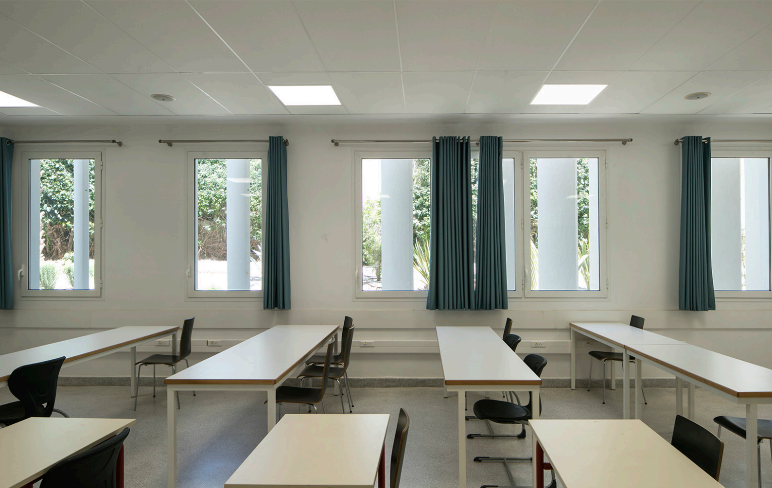
07 - Les salles de classes ont des fenêtres sur au moins deux façades pour créer des courants d'air. photo ©Edouard Decam
